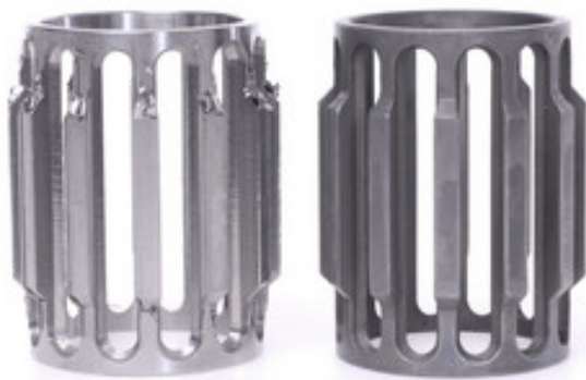
Explosionsentgraten: Vorher und nachher (Bild: Moser-Entgratungs AG)
